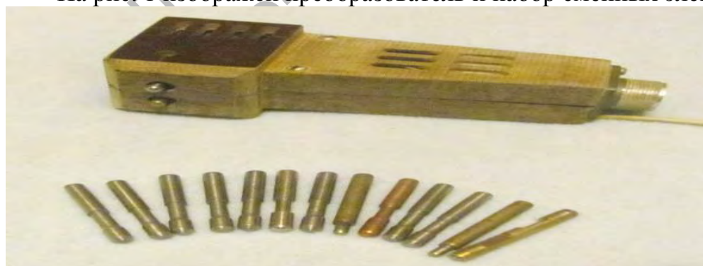
Рис. 1. Термоэлектрический преобразователь и набор сменных электродов из разных материалов
