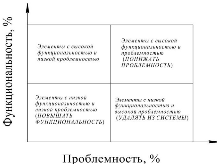
Рисунок 1.3 – Ранжирование и определение по четырем секторам функциональных элементов в координатах «функциональность – проблемность»
