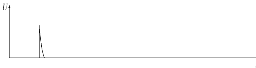
Рисунок 8.4 — Положительный импульс напряжения на выходе первой дифференцирующей цепи с отсекающим диодом
