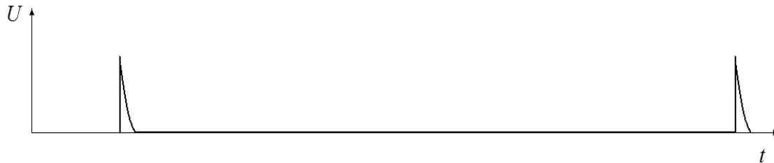
Рисунок 8.5 – Импульсы напряжения на выходе второй дифференцирующей цепи при перемещении кузова в процессе торможения автомобиля
