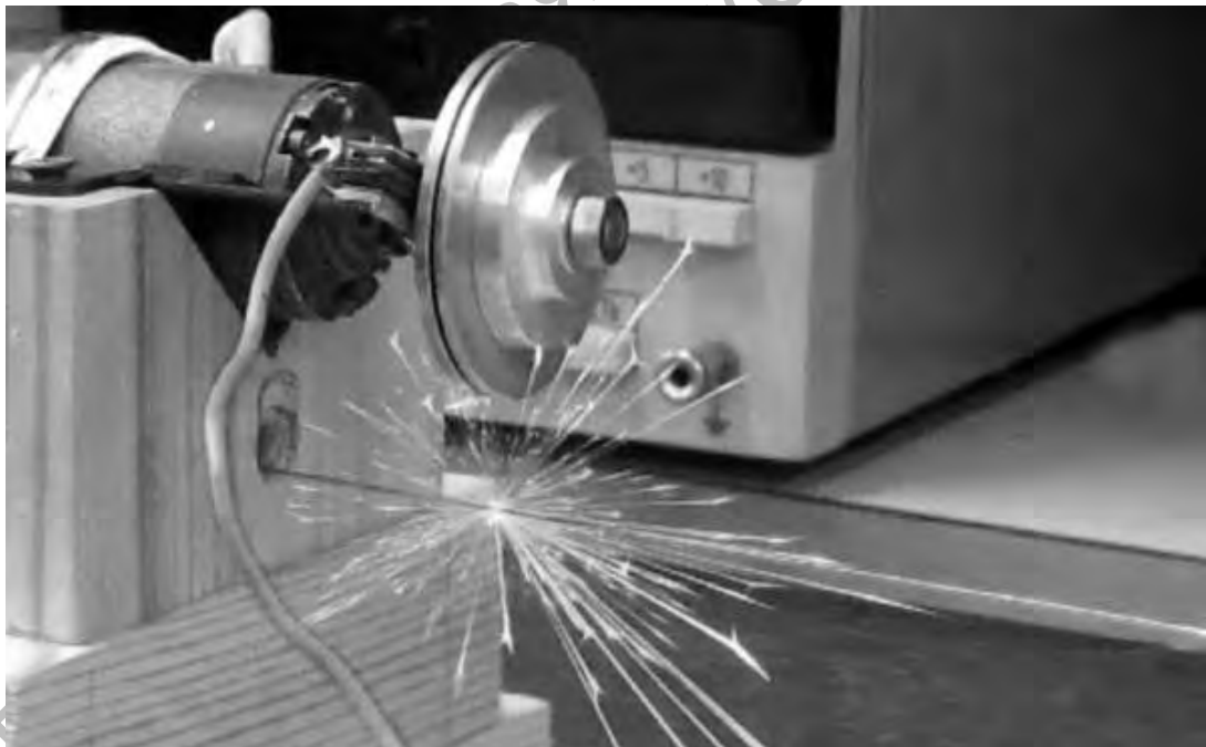
Рис. 3. Фотографии рабочих зон устройств для электроконтактной обработки поверхности проволоочного инструмента: а – с применением электромагнитного вибратора; б – с применением электромеханического вибратора
