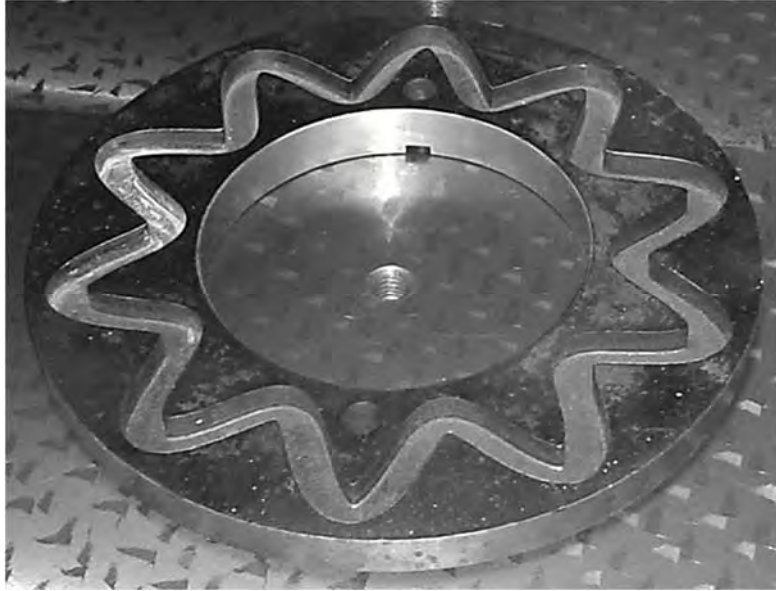
Рисунок 3.9 – Диск с многопериодной дорожкой
