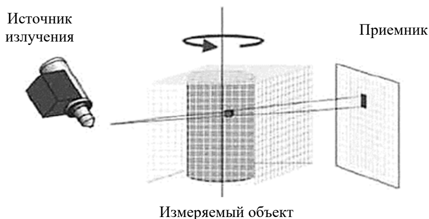
Рисунок 3.4 – Схема построения 3D-модели с использованием проникающего излучения
