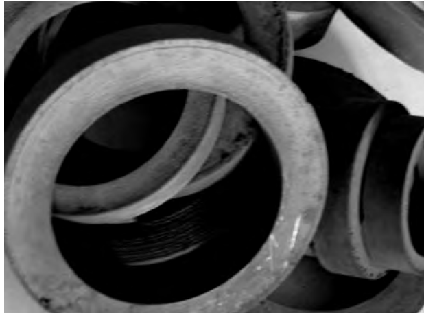
Рис. 1. Кольца волочильных машин с металлокерамическим покрытием
