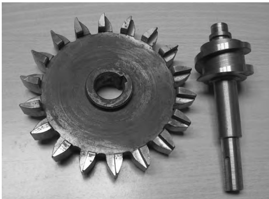
Рис. 4. Червячное колесо с поднутрением венца до граничных точек профилей зубьев и червяка
