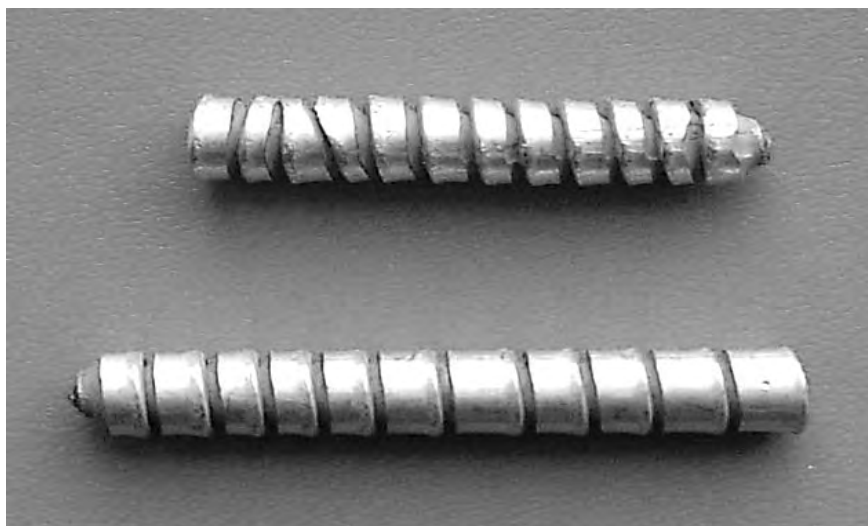
Рис. 5. Кольцевые разрывы на поверхности прутка диаметром 10 мм, образующиеся при переохладении контейнера
