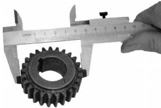
Рисунок 2.31 – Замер диаметра выступов колеса зубчатого
