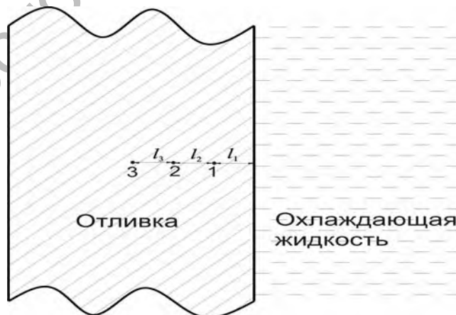
Рис. 5. Схема расположения термопар в экспериментальной отливке: l_1 = 5 мм, l_2 = 5 мм, l_3 = 5 мм
