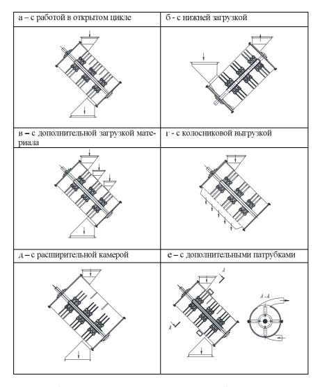
В таблице 2 е представлена молотковая дробилка с наклонным корпусом, который оснащен патрубками для подачи в рабочую камеру теплового газового агента и вывода конденсированного пара и влаги.
