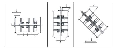
С целью дальнейшего совершенствования молотковых дробилок с управляемым движением обрабатываемой среды, которые основаны на установке ротора под углом к горизонту, предлагаются следующие конструктивные решения (таблица 2) [2,3].
