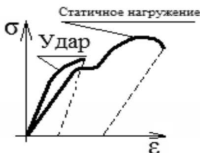
Рисунок 5.2 – Диаграммы растяжения при статическом и динамическом (удар) нагружении
