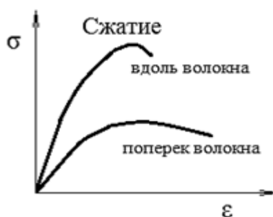
Рисунок 6.2 – Диаграммы сжатия деревянных образцов вдоль и поперек волокон
