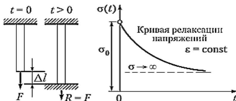
Рисунок 4.1 – Схема испытания на релаксацию напряжений и кривая релаксации напряжений
