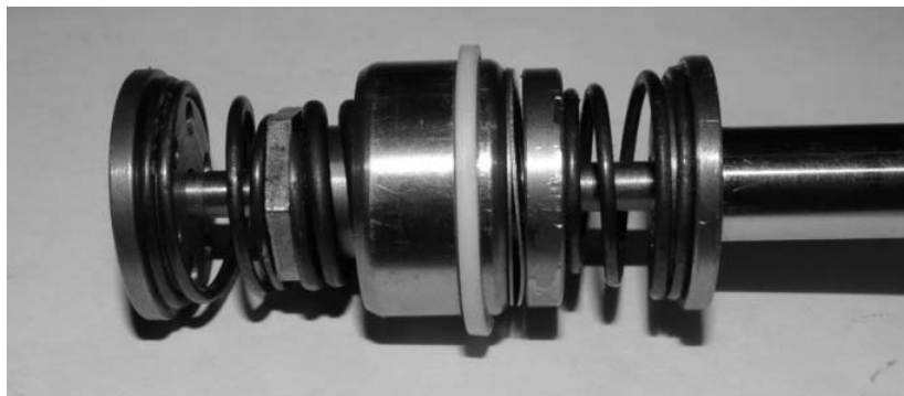
Рис. 2. Конструкция поршневого узла амортизатора в сборе
