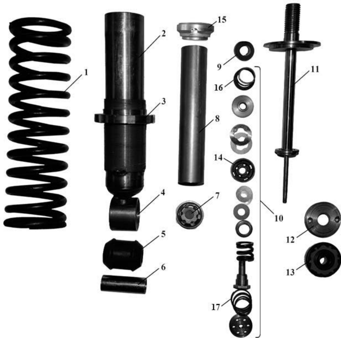
Рис. 1. Опытный демпфер системы поддресоривания кабины колесного трактора: 1 – цилиндрическая пружина; 2 – резервуар амортизатора в сборе; 3 – гайка пружины; 4 – проушина; 5 – резиновая втулка; 6 – втулка шарнира; 7 – клапан сжатия в сборе; 8 – цилиндр; 9 – буфер хода отбоя; 10 – детали поршневого узла; 11 – шток в сборе; 12 – гайка резервуара; 13 – сальник штока; 14 – поршень; 15 – направляющая втулка; 16 – верхняя пружина поршня; 17 – нижняя пружина поршня
