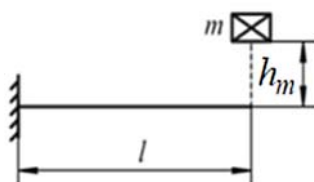
Рисунок 4.1 – Схема нагружения балки ударом
