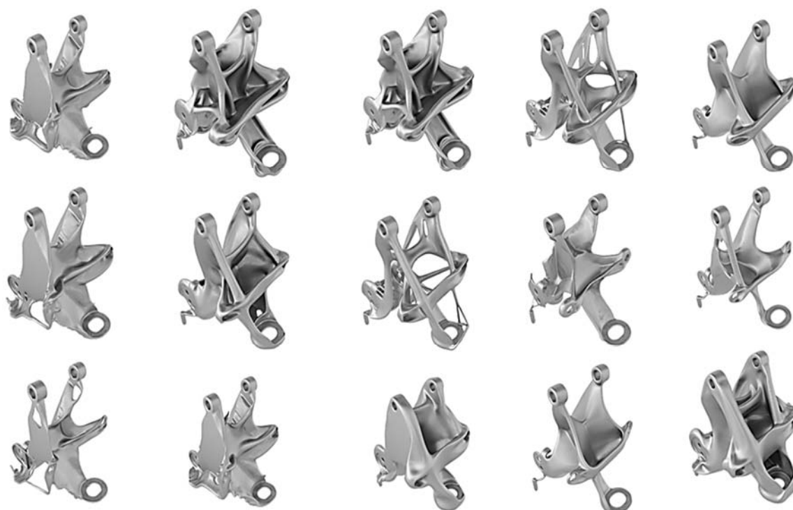
Рисунок 2.4 – Пример генеративного дизайна
