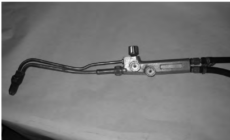
Рис. 6. Общий вид резака РЗГ
