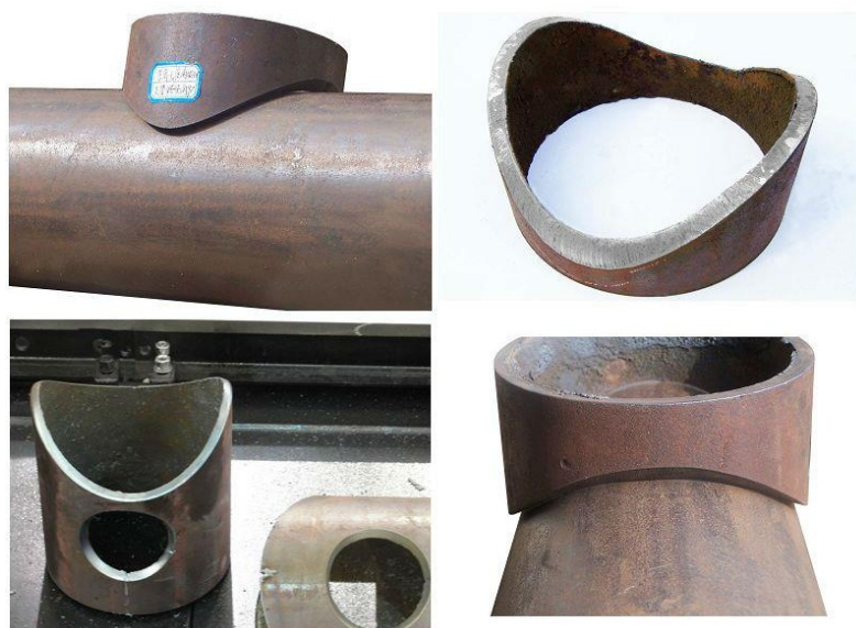
Рис. 1 Примеры фасонок для трубопроводов Аналогичная ситуация наблюдается при монтаже систем вентиляции и кондиционирования воздуха.
