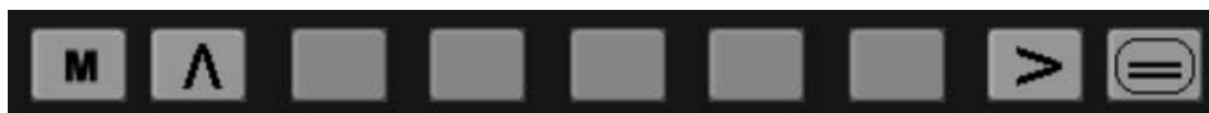
Рисунок 2.20 – Управляющие клавиши экрана пульта ЧПУ (слева направо: «М» («MACHINE»), «НАЗАД», пять опциональных клавиш, «ПРОЛИСТАТЬ», «MENU SELECT»)
