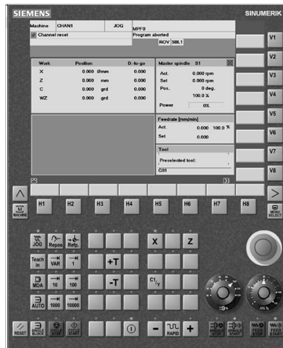
Рисунок 1.2 – Лицевая панель пульта оператора
