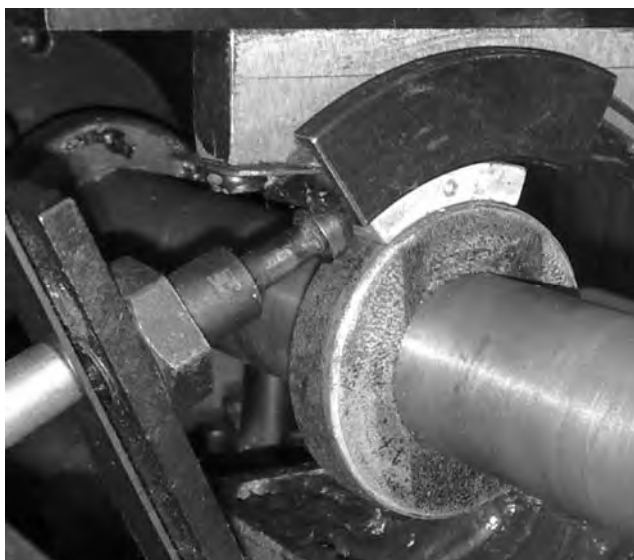
Рис. 1. Стенд для испытаний материалов на износ
