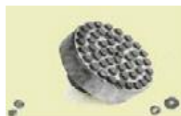
в) абразивный инструмент на основе композитов, содержащих УДА ЗД- топография
