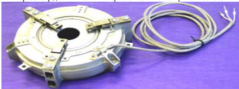
Трибометр для испытаний материалов на МКС в открытом космосе
