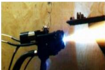
Рис. 5. Аппарат гиперзвуковой металлизации с малогабаритной камерой сгорания (ГМ)
