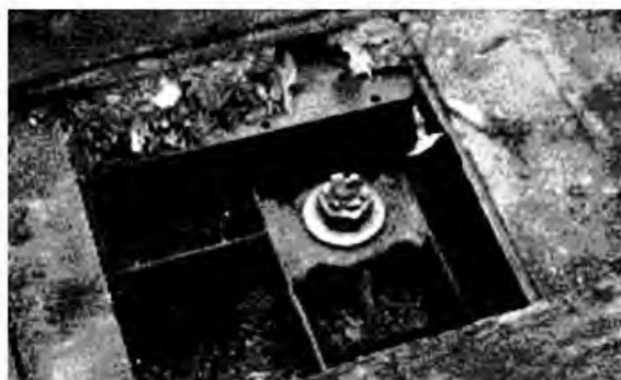
Рис. 6. Шкворень сцепного устройства автопоезда МАЗ-64229 + МТМ 9330 с датчиком измерения СИЛ: а – шкворень сцепного устройства с датчиком измерения сил; б – монтаж седельно-сцепного устройства на полуприцепе седельного автопоезда МАЗ-64229 + МТМ 9330
