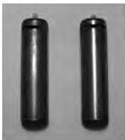
Рис. 4. Оси колодок барабанного тормоза автомобиля МАЗ-544018-320-030 с датчиком измерения момента
