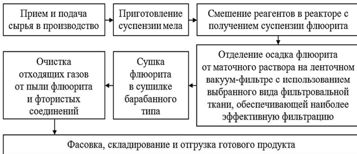
Рис. 1. Основные технологические стадии производства флюорита
