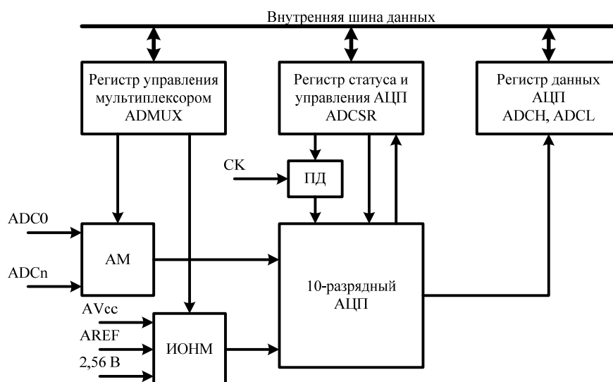
Рисунок 3.10 – Структурная схема модуля АЦП
