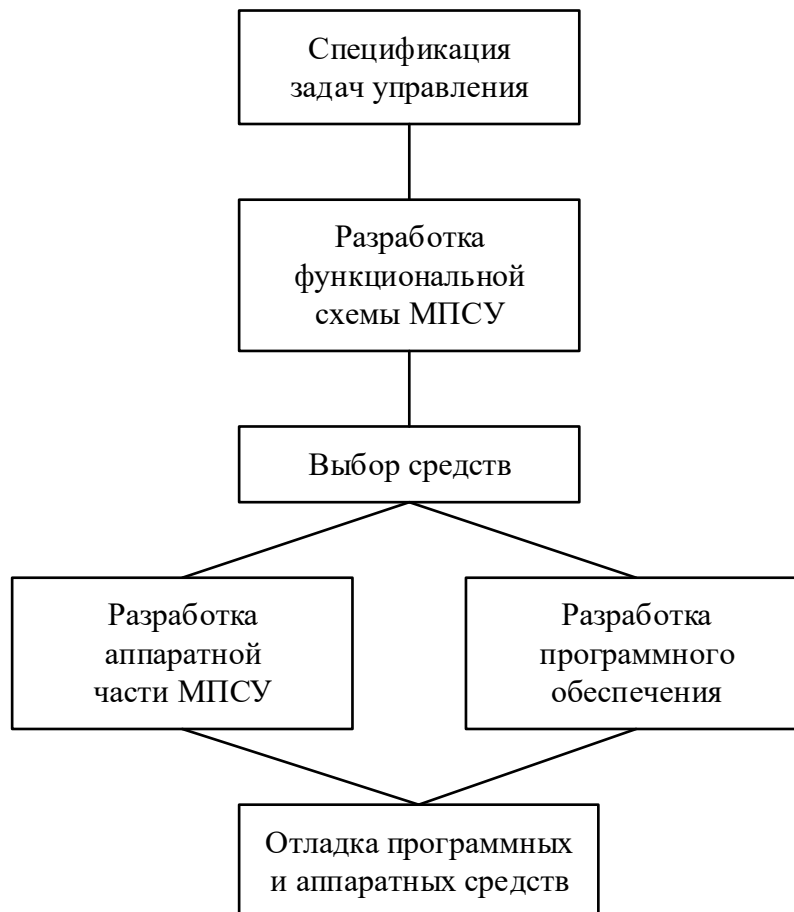
Рисунок 2.1 – Алгоритм проектирования МПСУ
