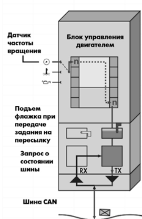
Рисунок 5.2 – Идентификация по поднятому «приемному флажку» нового послания в системе CAN силового агрегата
