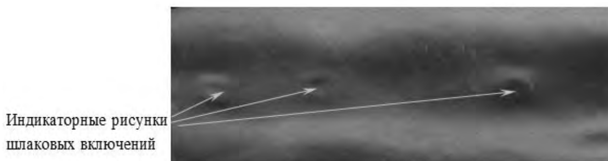
Рис. 8.3. Индикаторные рисунки шлаковых включений размером 3,2; 4 и 4,8 мм, находящихся в образце толщиной 12 мм на глубине 6 мм от поверхности
