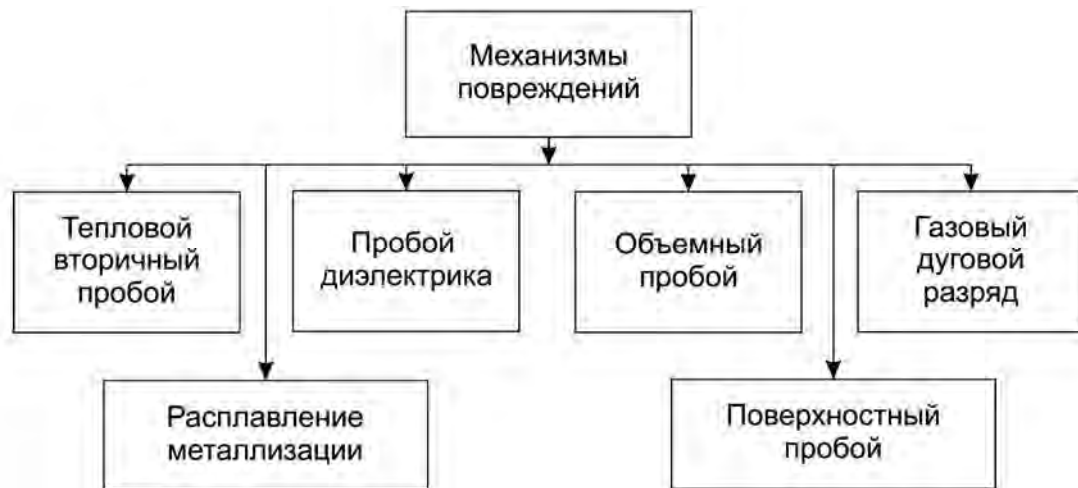
Рис. 1. Классификация механизмов повреждений микроконтроллеров при воздействии электростатических разрядов
