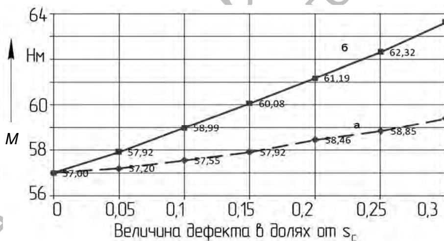
Рис. 8. Изменение нагруженности привода в зависимости от величины и места расположения дефекта
