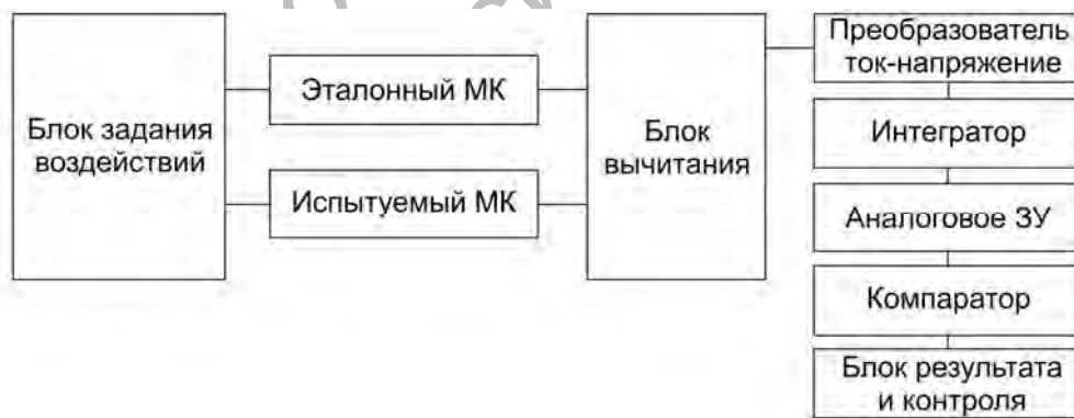
Рис. 4. Структурная схема устройства, реализующего функциональное тестирование микроконтроллера
