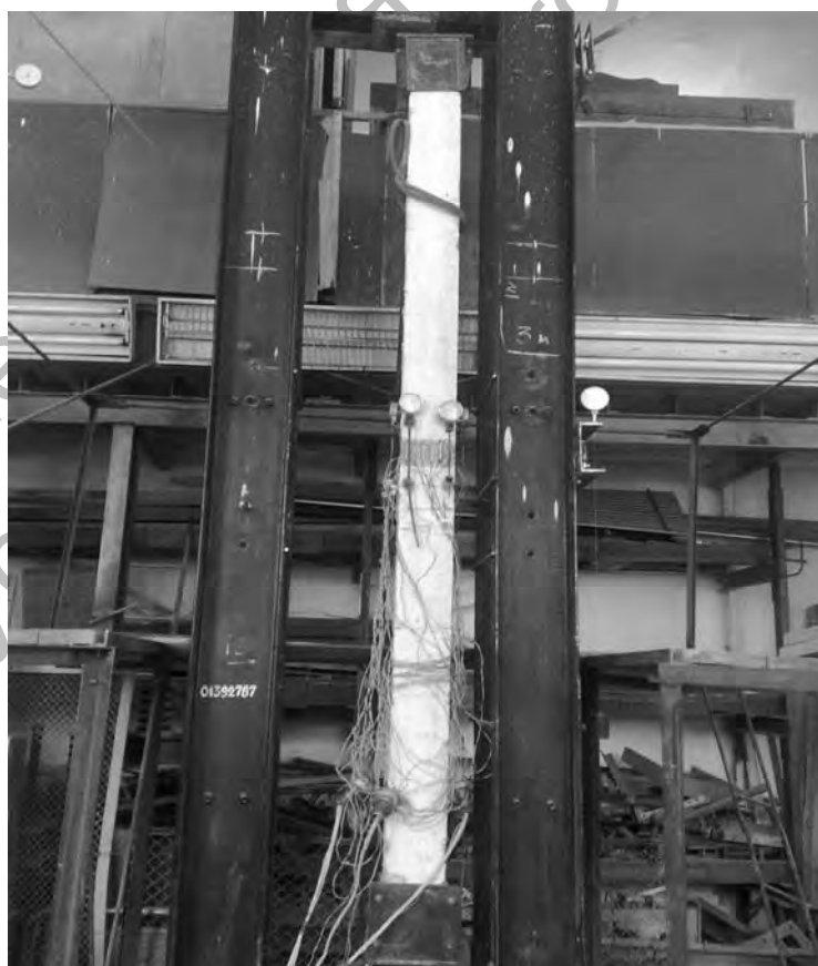
Рис. 2. Опытная колонна с измерительными приборами в установке для испытания
