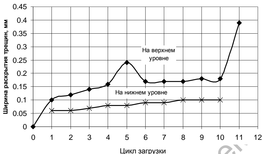
Рис. 5. Развитие ширины раскрытия трещин в колоннах марки 1КЗН-3
