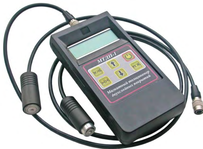
Рис. 1. Внешний вид магнитного толщиномера двухслойных покрытий МТДП-1
