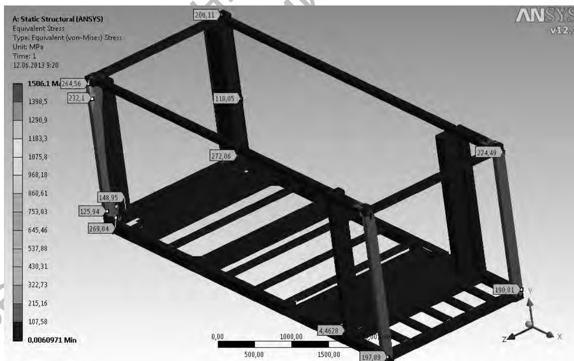
Рис. 5. НДС контейнера при штабелировании нагрузкой 1650000 Н
