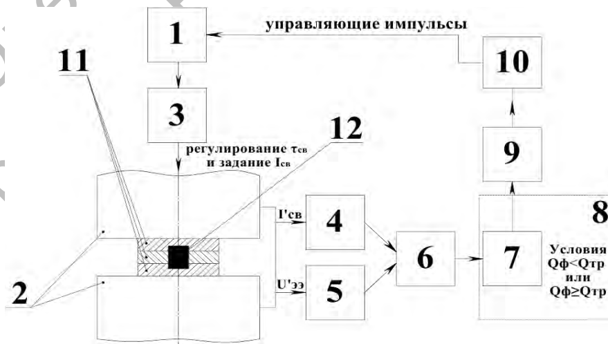
Рис. 4. Структурная схема системы автоматического управления процессом контактной рельефной сварки
