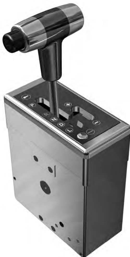
Рис. 2. Селектор режимов управления гидромеханической передачей
