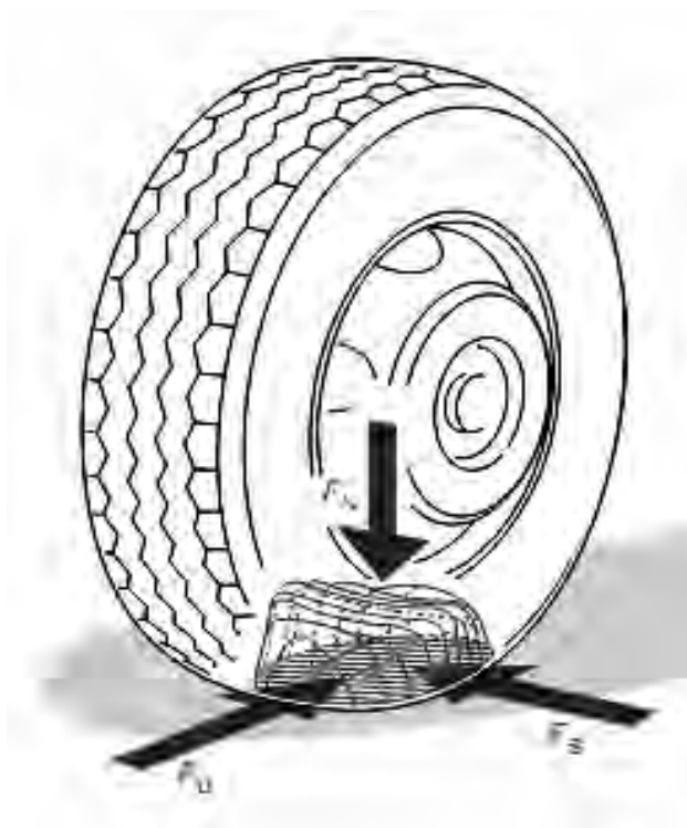
Рис. 1. Силы, возникающие в пятне контакта колеса с опорной поверхностью [4]: F_N – нормальная нагрузка; F_U – тормозная сила; F_S – поперечная сила
