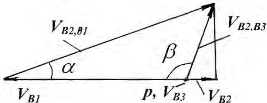
Рис. 2. Планы скоростей механизма с промежуточными телами качения
