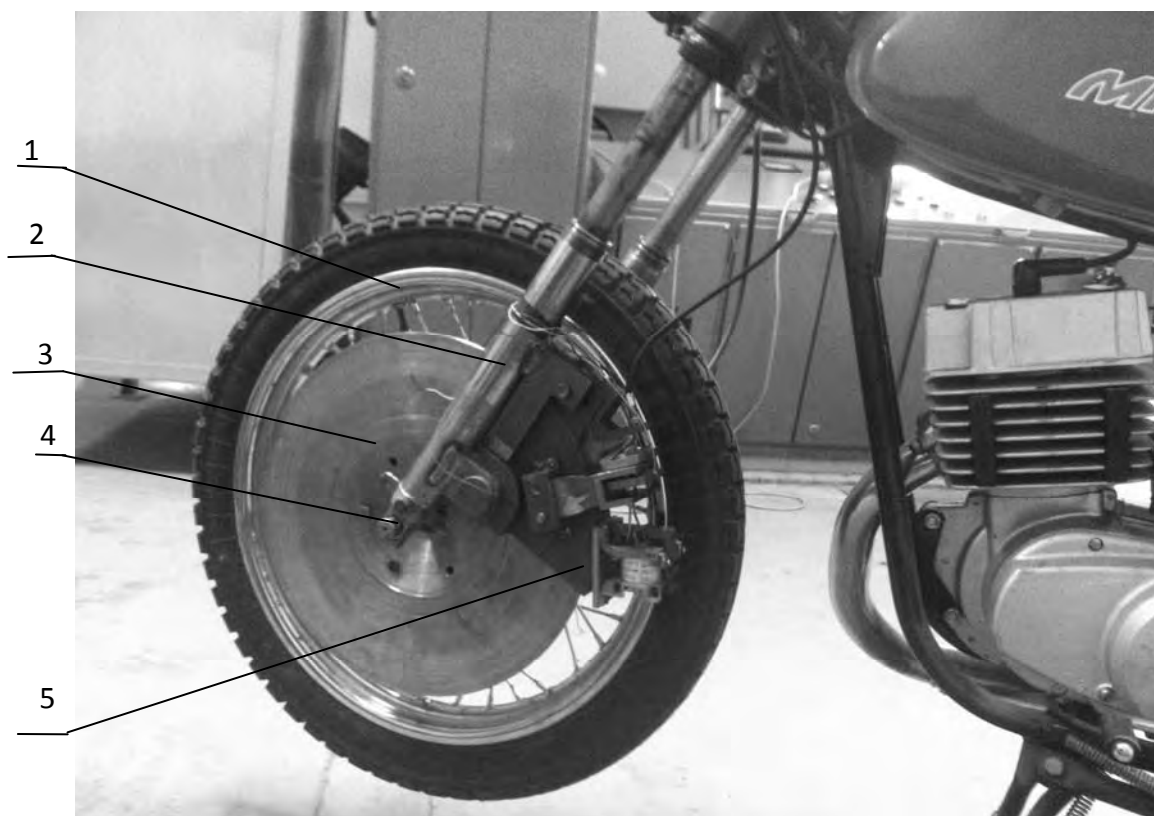
Рис. 5. Устройство измерения боковых реакций на колесо мотоцикла, оснащенного системой активной безопасности: 1 – колесо; 2 – труба передней вилки; 3 – тормозной диск; 4 – устройство измерения боковых реакций; 5 – тормозной механизм с элементами регулирования тормозного момента
