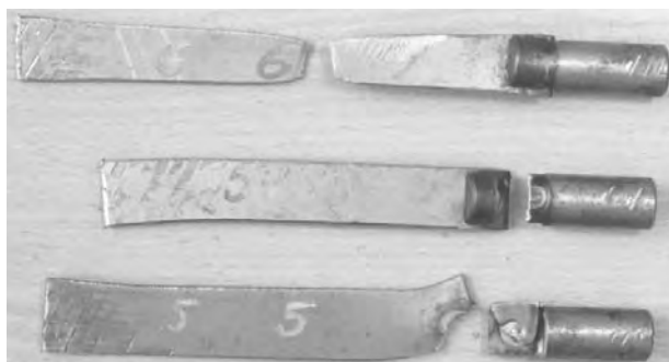
Рис. 11. Характер разрушения образцов, полученных при сварке с использованием системы автоматического управления процессом КРС засова
