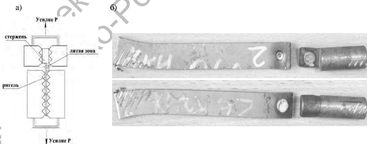
Рис. 8. Схема прочностных испытаний (а) и фотографии разрушенного образца (б)
