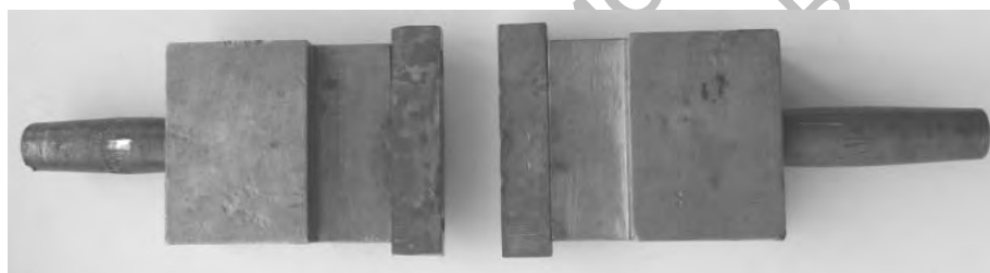
Рис. 6. Составной электродный узел для сварки засова: 1 – бронзовая насадка; 2 – медная накладка; 3 – электрод с конической поверхностью
