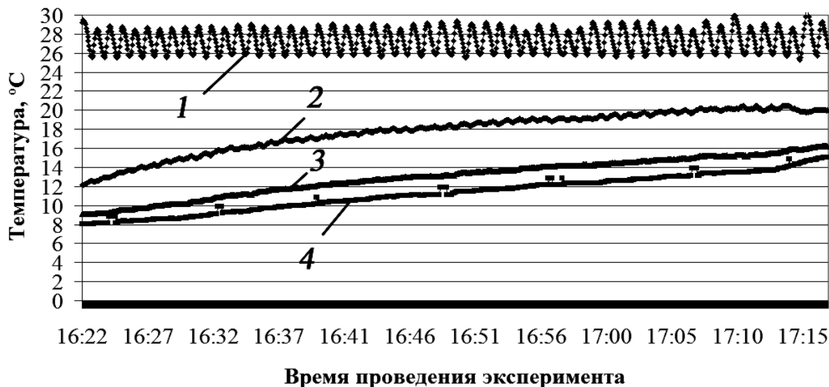
Рис. 3. Показания термодатчиков при нагреве цилиндрического образца высотой 80 мм: 1 – термостат; 2 – датчик 1; 3 – датчик 2; 4 – датчик 3
