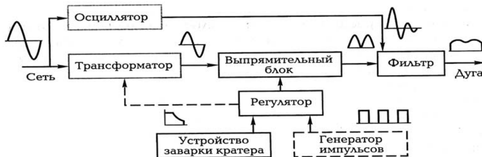
Рисунок 5.2 – Функциональная схема источника питания постоянного тока для аргонодуговой сварки
