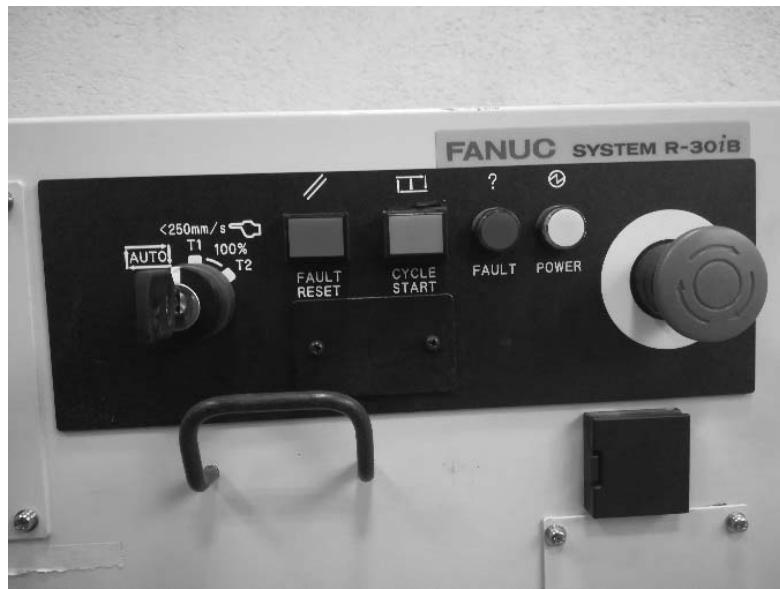
Рисунок 11.5 – Лицевая панель контроллера робота
