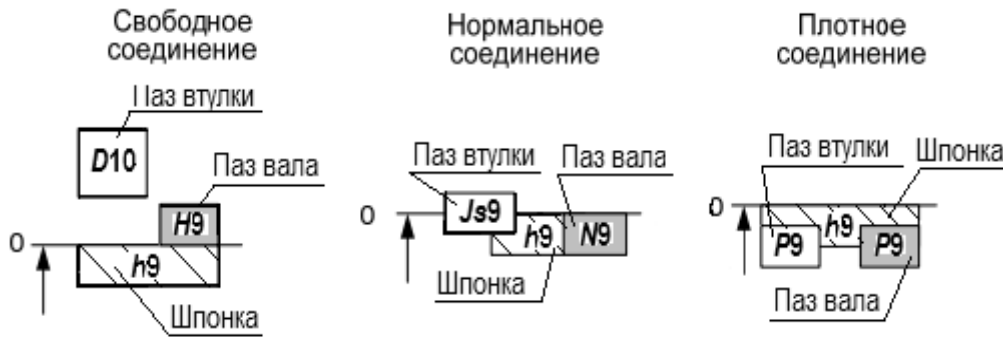
Рисунок 7.4 – Поля допусков шпоночных соединений по ширине паза (шпонки)
