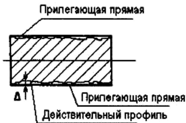
Рисунок 1.2 – Отклонение профиля продольного сечения
