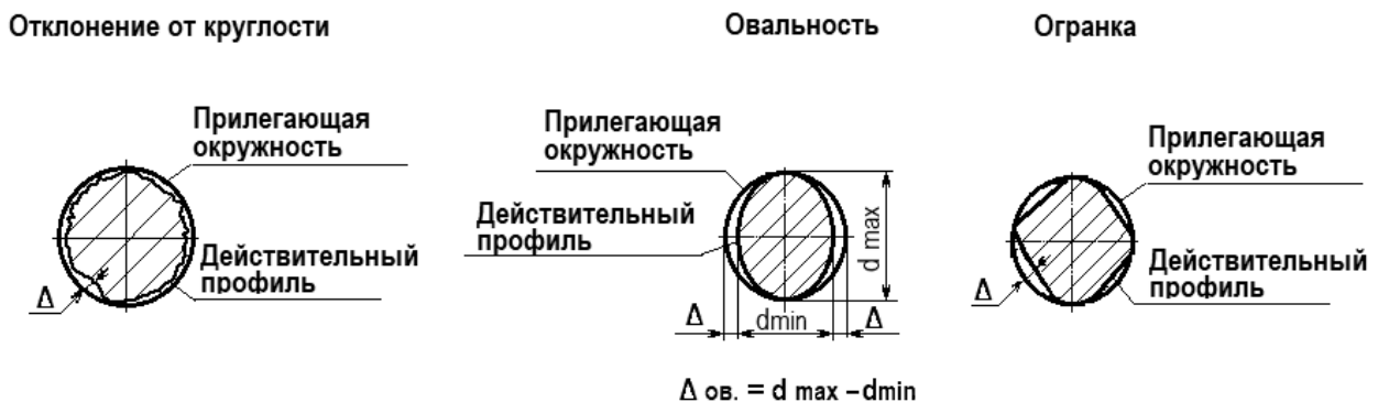
Рисунок 1.1 – Погрешности формы цилиндрических деталей в поперечном сечении
