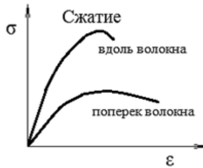
Рисунок 3.2 – Диаграммы сжатия деревянных образцов вдоль и поперек волокон
