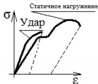
Рисунок 7.2 – Диаграммы растяжения при статическом и динамическом (удар) нагружении
