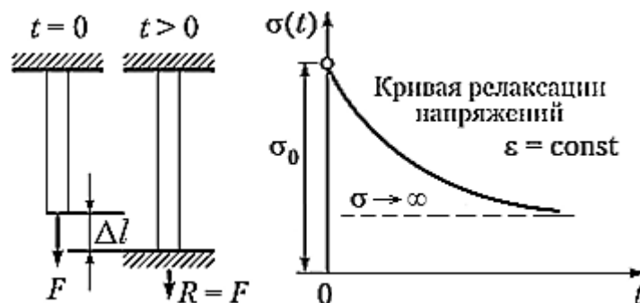
Рисунок 5.1 – Схема испытания на релаксацию напряжений и кривая релаксации напряжений
