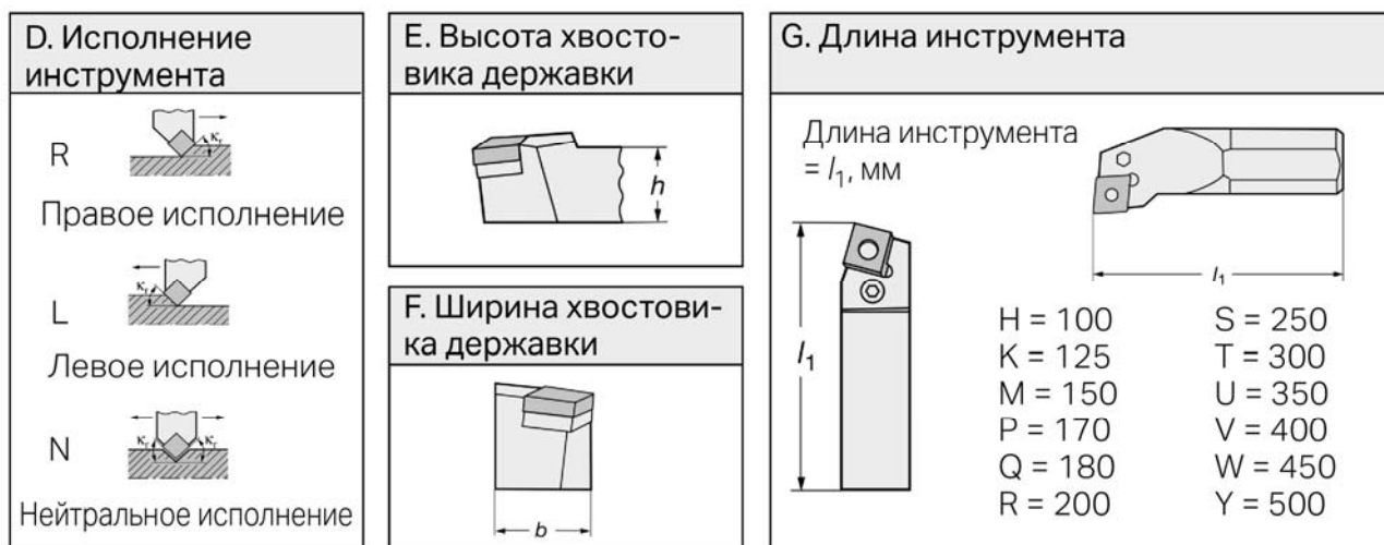
Рисунок 7.11 – Схема записи размеров державки
