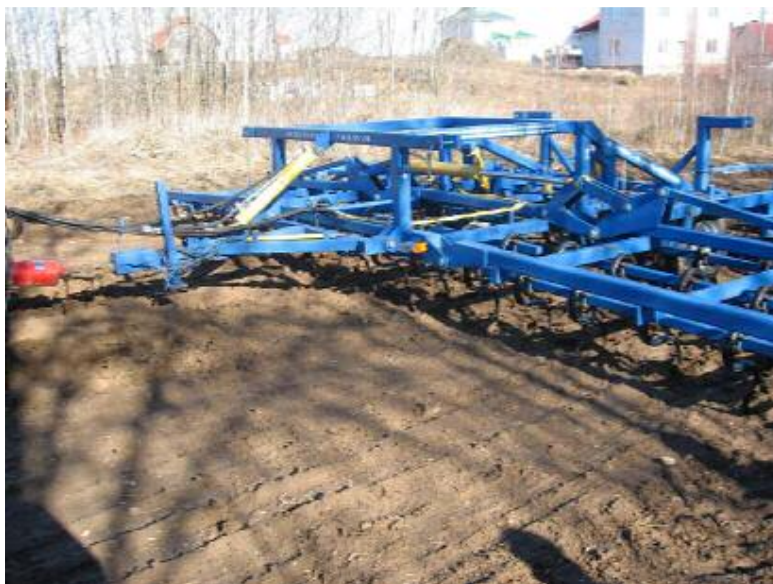
Рис. 1. Динамометрирование культиватора КП-9 весами ВКЭ-5
