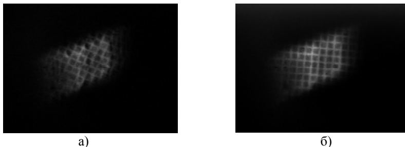
Рис. 2. Изображение золотой сетки № 1000, полученное с помощью микроскопа: а) экспозиция 1 мин; б) экспозиция 10 мин
