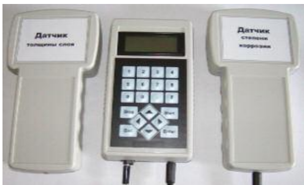
Рис. 1. Внешний вид прибора для оценки степени коррозии стальной арматуры в железобетонных изделиях
