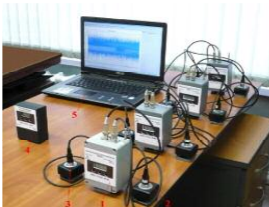
Рис. 1. Многоканальный комплекс входного виброконтроля с дистанционным управлением, построенный на основе 4-х двухканальных виброизмерительных блоков: 1 – виброизмерительный блок; 2, 3 – датчики вибрации; 4 – пульт дистанционного управления; 5 – ноутбук с программой вибродиагностики.
