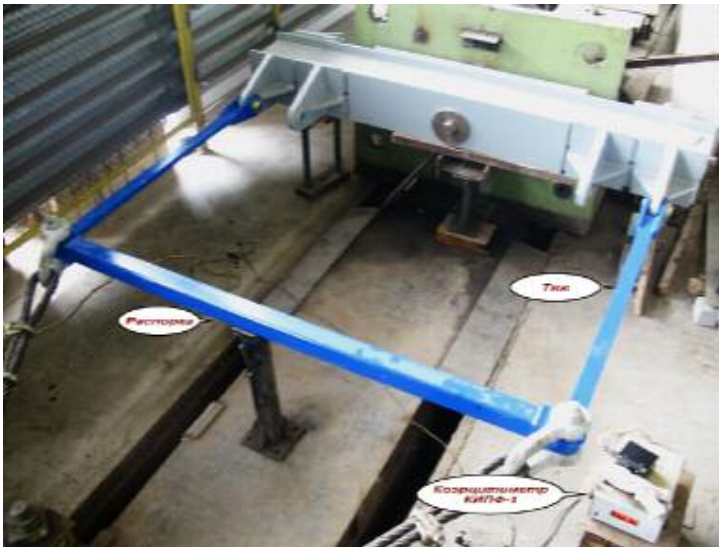
Рис. 1. Вид стержневой конструкции в составе испытательного стенда
