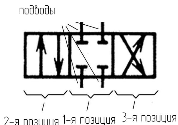
Рисунок 12.2 – Схема распределителя
